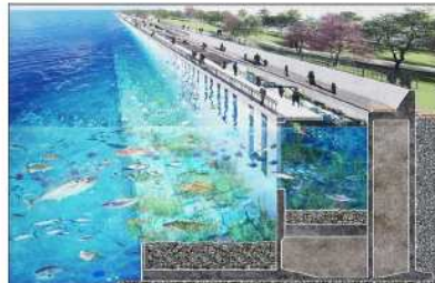
【生物共生型港湾構造物の整備】
