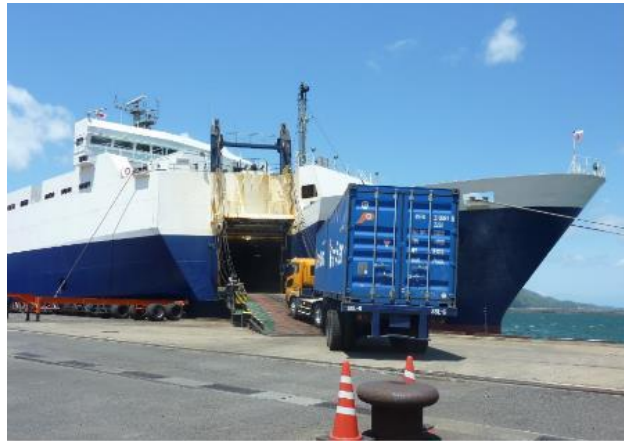
RORO船の荷役状況
